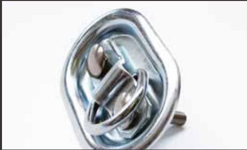
In houten vloer verzonken ringen, trekkracht elk 0,2 t (4 stuks)
